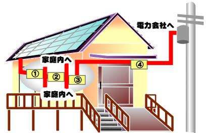
①接続箱 → ②パワーコンディショナー → ③分電盤 → ④電力計
